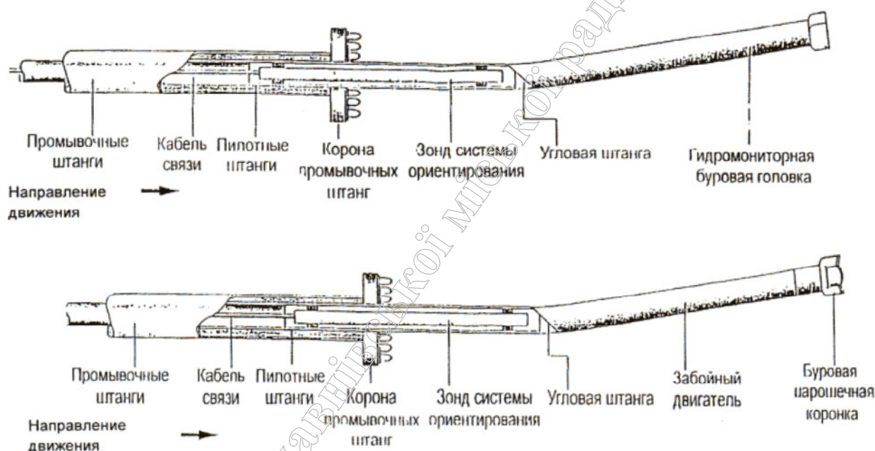
Рис. 2. Буровой инструмент для мягких и твердых пород
